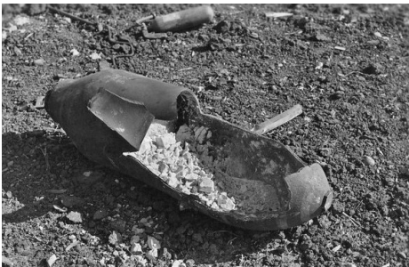
12. kép: Egy félíg felrobbant AN-M64-es bomba a robbanótöltet maradványával https://www.flickr.com/photos/juliaem/7888927328/in/album-72157631068974024/ (Megtekintve: 2020. február 10.)
